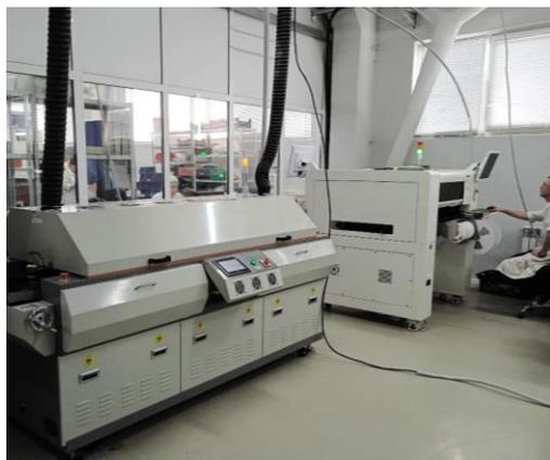
Оборудование автоматизированной установки, пайки электронных компонентов на плате.
