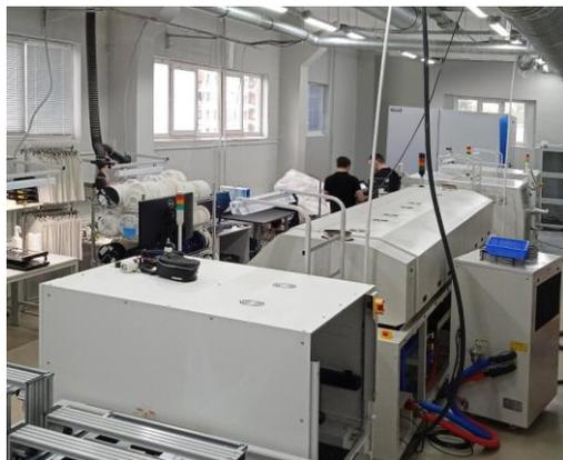
Линия автоматизированного поверхностного монтажа компонентов на плату с оптическим контролем качества сборки.
