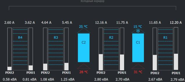
Кондиционер 1 Кондиционер 2 Модель NetCol5000-A025H4WE2 Питание Вкл 91 % Работа вентиляторов 63 % Охлаждение Вкл на входе на выходе Температура воздуха 15.1 °C 31.3 °C Влажность воздуха 11 % 27 % 20.0 °C HotAisleAir Уставка температуры
