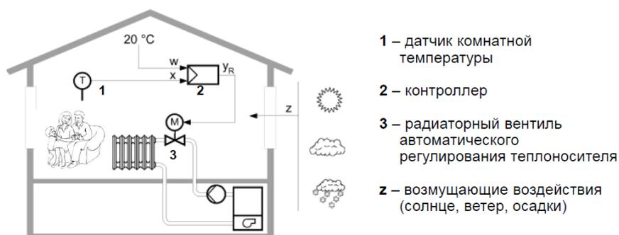
Для этого используется автоматический узел регулирования, где вместо стеклянного термометра установлен температурный датчик, а вместо ручного вентиля – регулирующий клапан с приводом. Наличие автоматики повышает ощущение комфорта.
